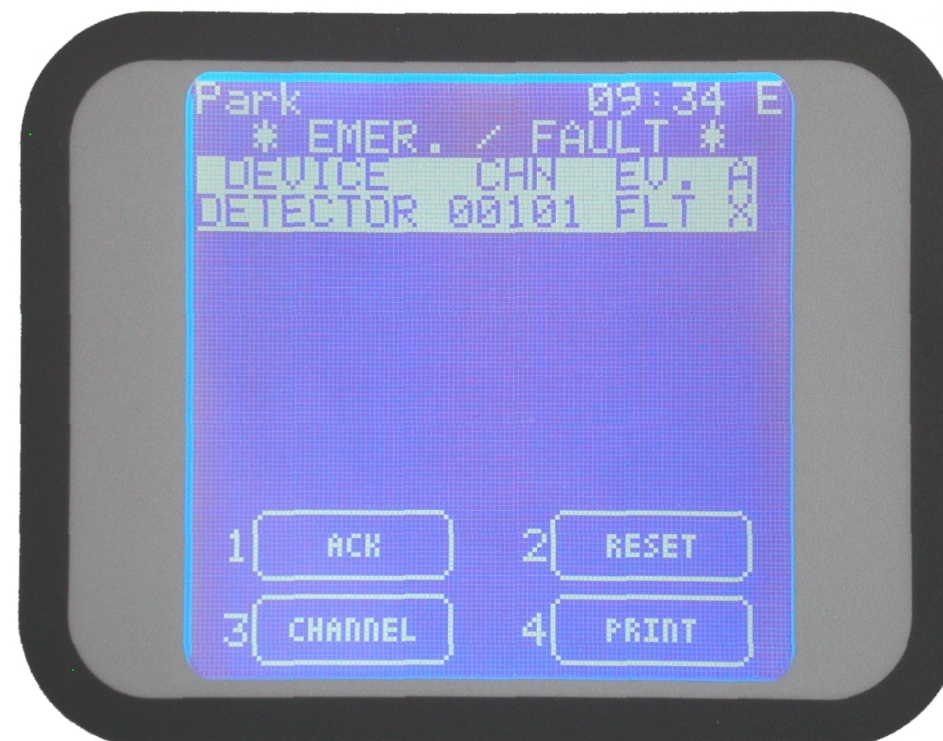
Figura 23 Videata in stato di Guasto
