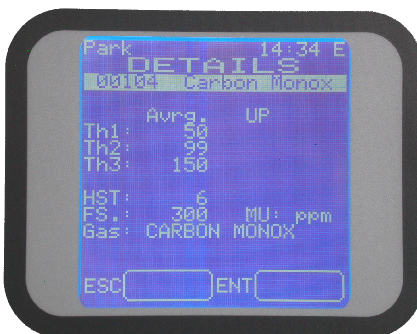
Figura 42 Dettagli configurazione rilevatore gas
